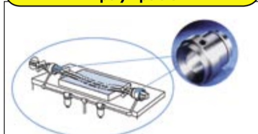
3. Ekstruusio • kumin muokkaaminen • jäähdytys ja kuivaus
